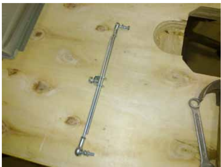
Крепление регулировочной тяги к мотору
